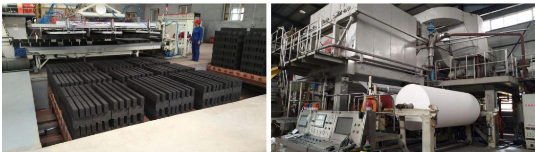
图 2—新邱天合环保建筑材料厂：用煤矸石制砖，利用隧道窑余热造纸
